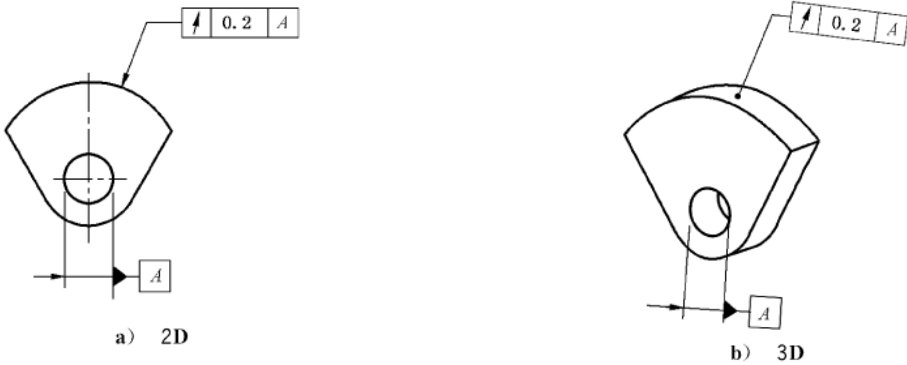
图 176 圆跳动标注
