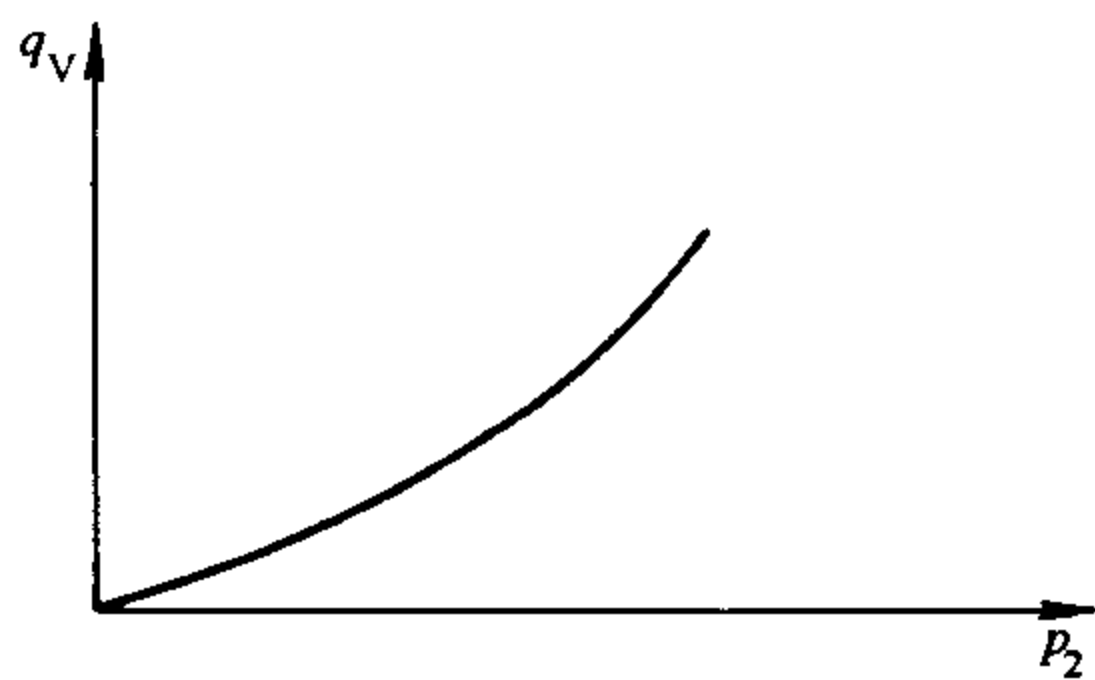
图 A.5 出口压力—外泄漏量曲线
