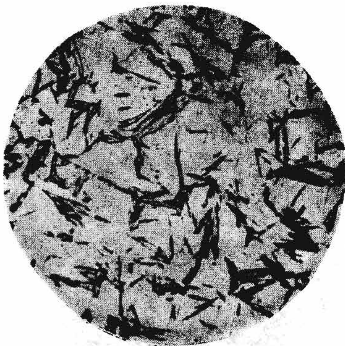
第 7 级 (粗针马氏体, 针的长度 12\sim 16\text{ mm} )
