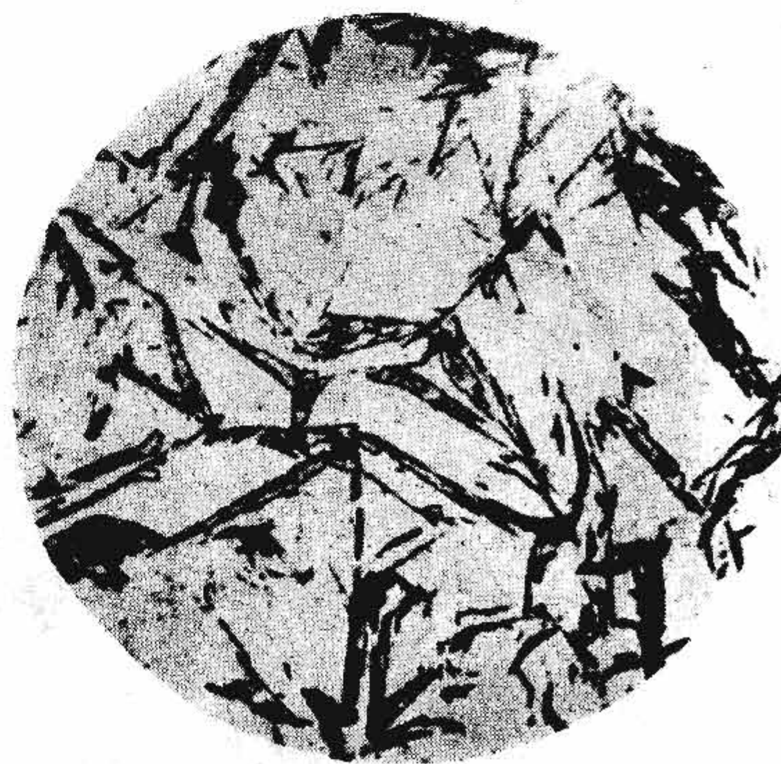
第 8 级 (粗针马氏体, 针的长度 >16\sim 25\text{ mm} )
