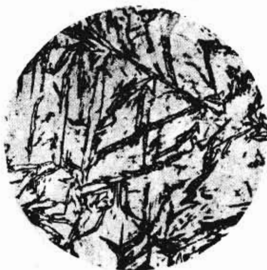
第 9 级 (粗针马氏体, 针的长度 >25 \sim 50 \text{ mm} )
